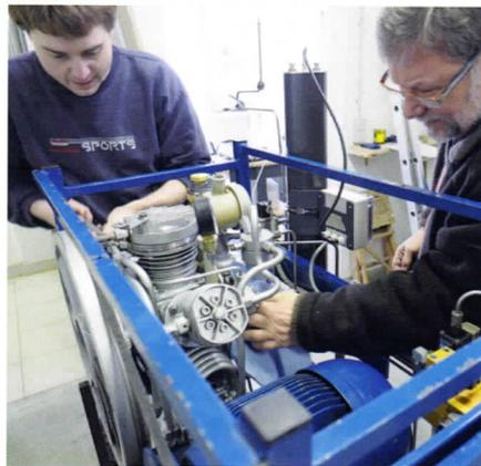
Nun führt Hubschi noch eine Luftmessung durch. Das Resultat ist: unser Kompressor liefert Luft von hoher Qualität. Dafür erhalten wir von Bauer das „Pure Air“ Zertifikat.
