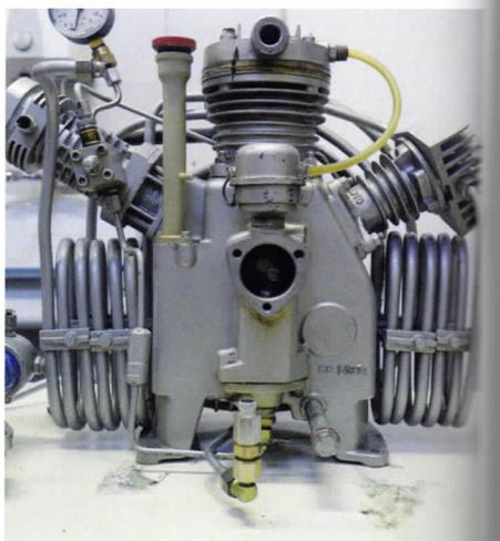
Währenddessen zerlegen Ulrich und Mansur die verschiedenen Ventile. Das Innere wird inspiziert und falls nötig diverse Teile ausgetauscht. Meistens sind die O-Ringe fällig. Die mit dem eckigen Querschnitt werden durch welche mit rundem ersetzt. Als der gereinigte Motorblock wieder zurück ist lassen wir das Öl ab. Danach demontieren wir die Zylinder. Die Kolben und Kolbenringe werden auf Verschleiß begutachtet.
