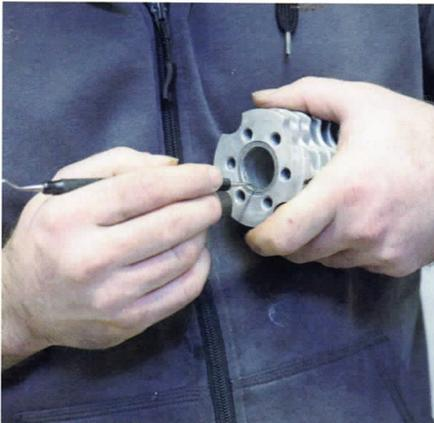
Die alten Zylinderköpfe werden gegen neue ausgetauscht. Dabei lernen wir, dass die schwarze Paste für die Dichtungen nicht „gefährlich“ ist. Wichtig ist bei der Montage der Zylinderköpfe die Einbaulage. Die muss stimmen, sonst funktioniert das Ding nachher nicht mehr.
