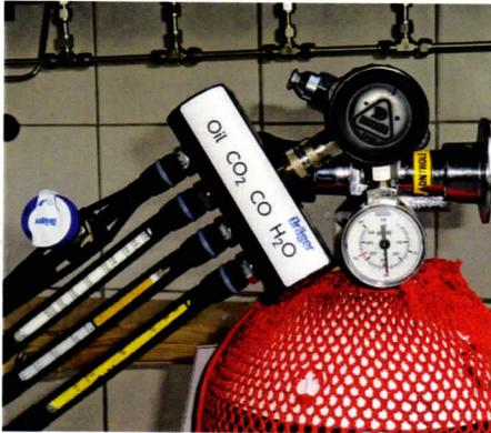
Zur Kontrolle der Luftqualität der durch den TSC – Kompressor erzeugten Pressluft für unsere Tauchflaschen ist eine jährliche Über-prüfung mittels eines Air-labs erforderlich.
